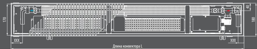
Вид сверху конвектора Qtherm 180.110 с роликовой решеткой с U-образным бортом, с дренажом
