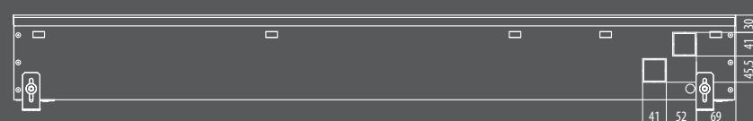
Вид сбоку конвектора Qtherm 180.150 с U-образным бортом
