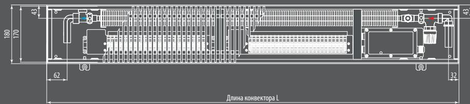
Вид сверху конвектора Qtherm 180.75 с роликовой решеткой с U-образным бортом
